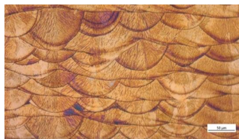
Fig. 1 (balra): Tiszta titán elektrolitikus polírozás után. Hagyományos maratás feszültség nélkül hígított Weck' reagenssel (0.5 % vízben oldott ammónium hidrogén bifluorid).
