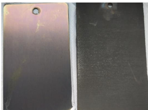
1. ábra – Azonos paraméterekkel vasfoszfátózott acéllemez és vasöntvény
